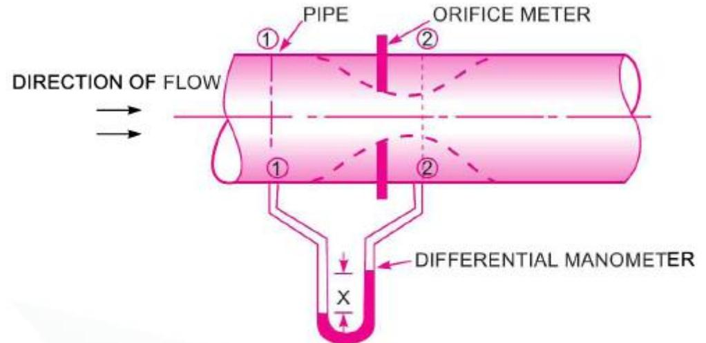
Fig. 6.12. Orifice meter.
