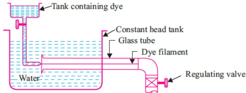
Fig.10.1. Reynolds apparatus.
